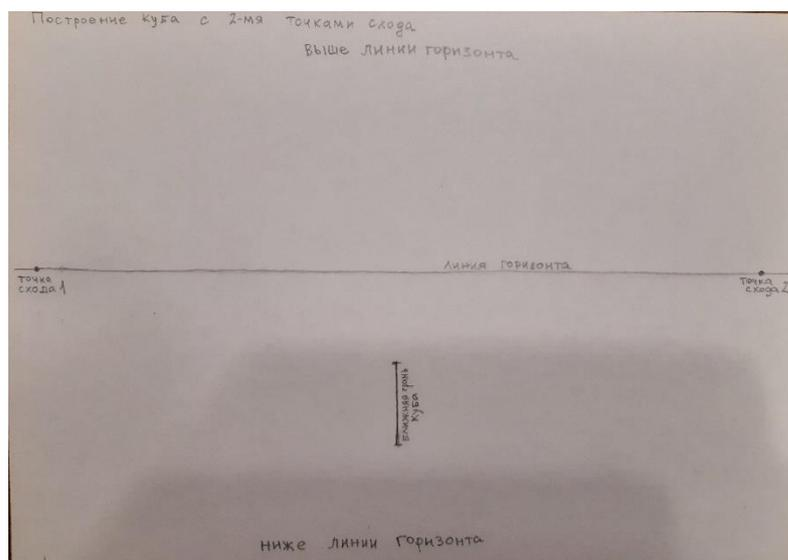
1. Проводим линию горизонта. Отмечаем точки схода. В нижней части отмечаем ближнюю грань куба. Намечаем ее небольшой.
